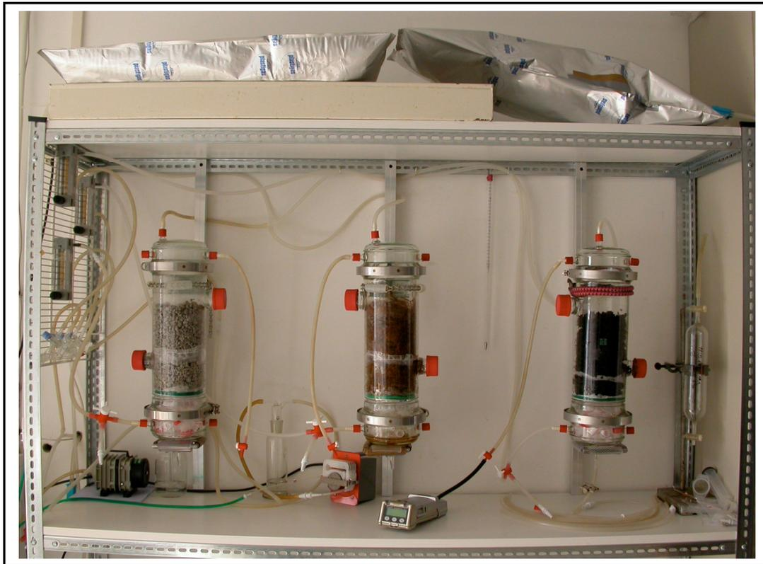
**Abb. 2.** Ansicht der verwendeten Laborbiofilter im Versuchsstand.
